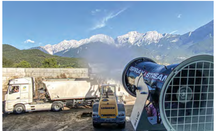
Die Kanone bindet Staub- und Geruchsmoleküle an die Oberfläche der Wassertropfen und neutralisiert gleichzeitig die Gerüche
